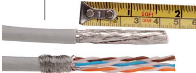
Isolieren Sie ca. 40 mm der Kabelummantelung ab.
